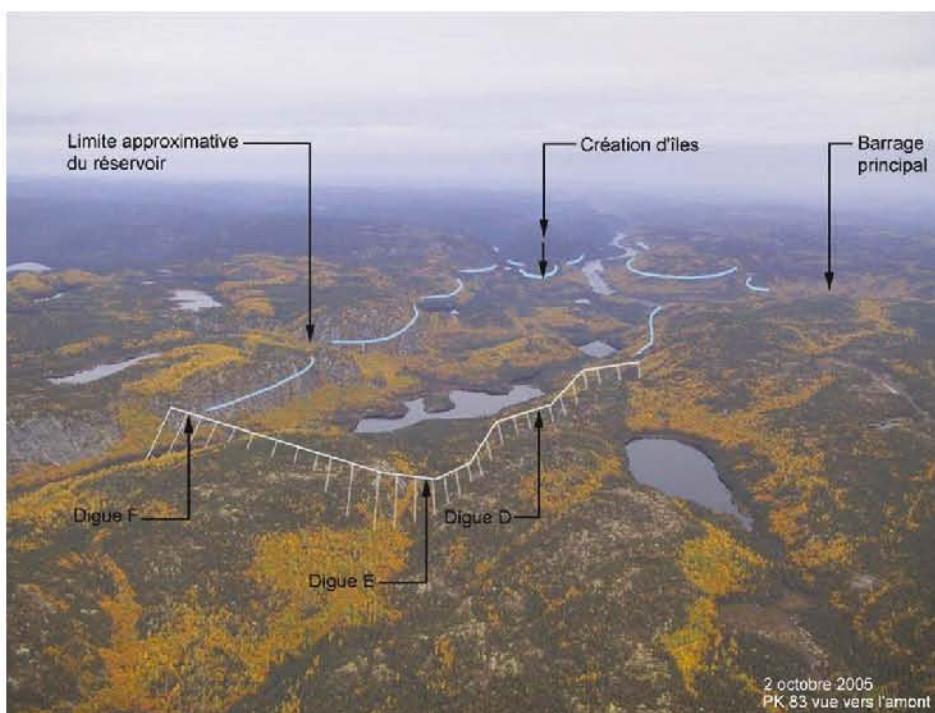
Photo QC-180-12 : Emplacement des digues D, E et F et limite approximative du réservoir de la Romaine 2 (PK 83, vue vers l'amont)
